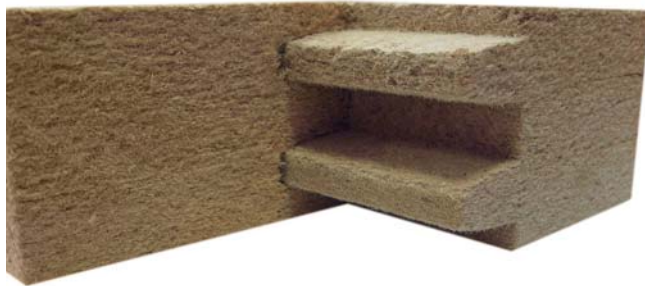
Doska Hofafest UD na izolovanie striech formou nadkrokovovej izolácie a taktiež na vytvorenie odvetraných fasád. V ponuke sú ešte tepelnoizolačné panely na všetky konštrukčné časti, fasádne omietateľné dosky a podlahové akustické dosky. V prípade klasických masívnych murovaných alebo panelových konštrukcií sa dajú použiť aj ako kontaktná izolácia. Hofatex Smrečina
